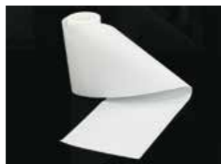
纤维素纳米纤维的多孔连续薄膜
