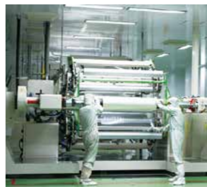
制造光学功能产品的New Tac Kasei山本工厂的清洁涂布机
