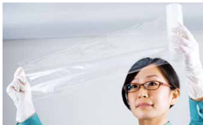
纤维素纳米纤维的透明连续薄膜
