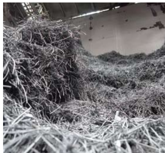
废轮胎中含有的电线。电线会引起操作过程中的很多故障，比如堵塞管道等。
