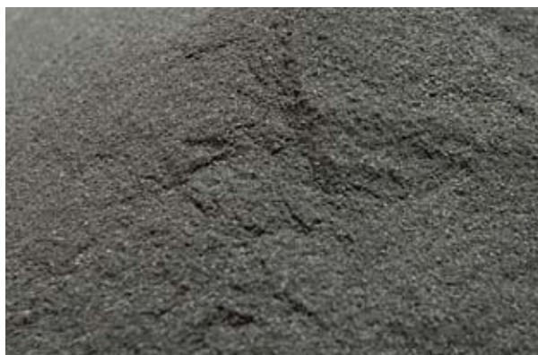
燃烧以后的 PS 灰。可以作为水泥原料和土壤改良材料来有效进行使用。
